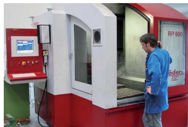
De RP 600 bij ARTooling, met een bewerkingsbereik van 600 mm x 500 mm x 300 mm. De machines van Röders zijn vanaf twee zijden toegankelijk. Dat heeft onder meer als voordeel dat de machine toegankelijk blijft voor de operator bij de overstap naar robotbelading (foto: Jan Oonk)
