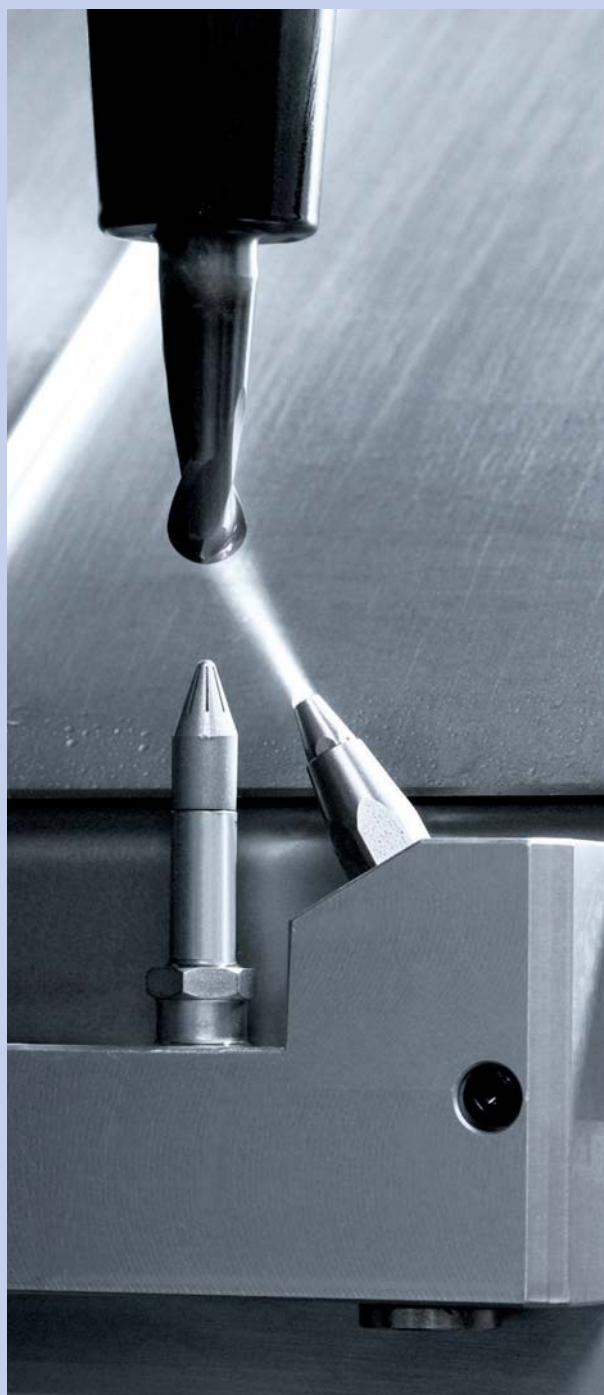
Een speciale sproei-inrichting zorgt ervoor dat gereedschappen na elke cyclus worden gereinigd. Dat zorgt er ook voor dat controlemetingen niet worden verstoord (foto: Röders)
